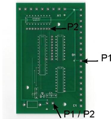
Zum Abschluß, nachdem die Steuerung stromlos gemacht wurde, setzen wir die IC ein. Auch hier bitte auf die Einkerbung an den IC und der Platine achten.
